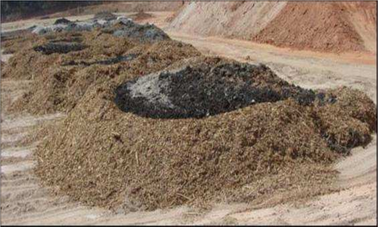
Figura 2 - Bacias formada com cascas de eucalipto para receber os demais resíduos
