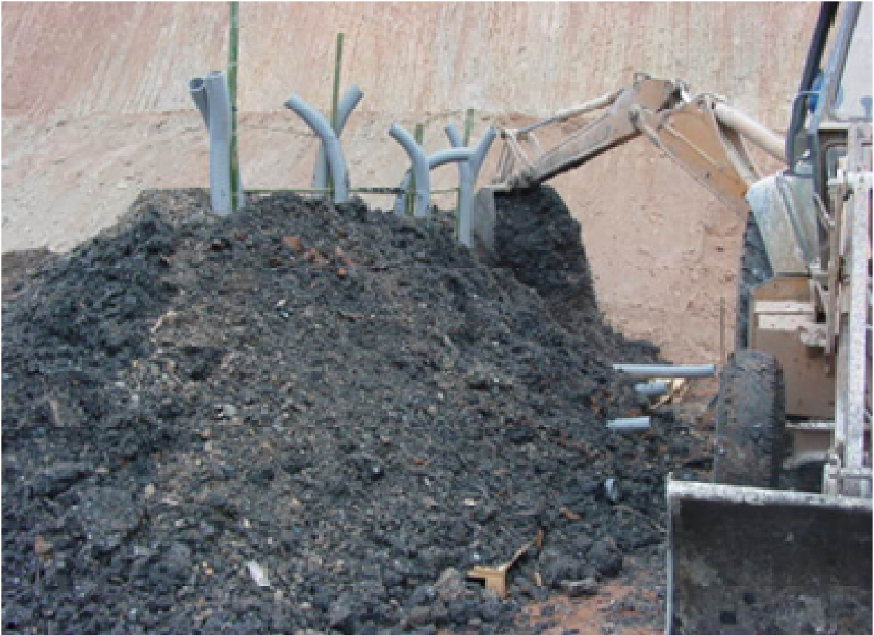
Figura 4 - Montagem das leiras de compostagem com os tubos flexíveis para facilitar a aeração do material
