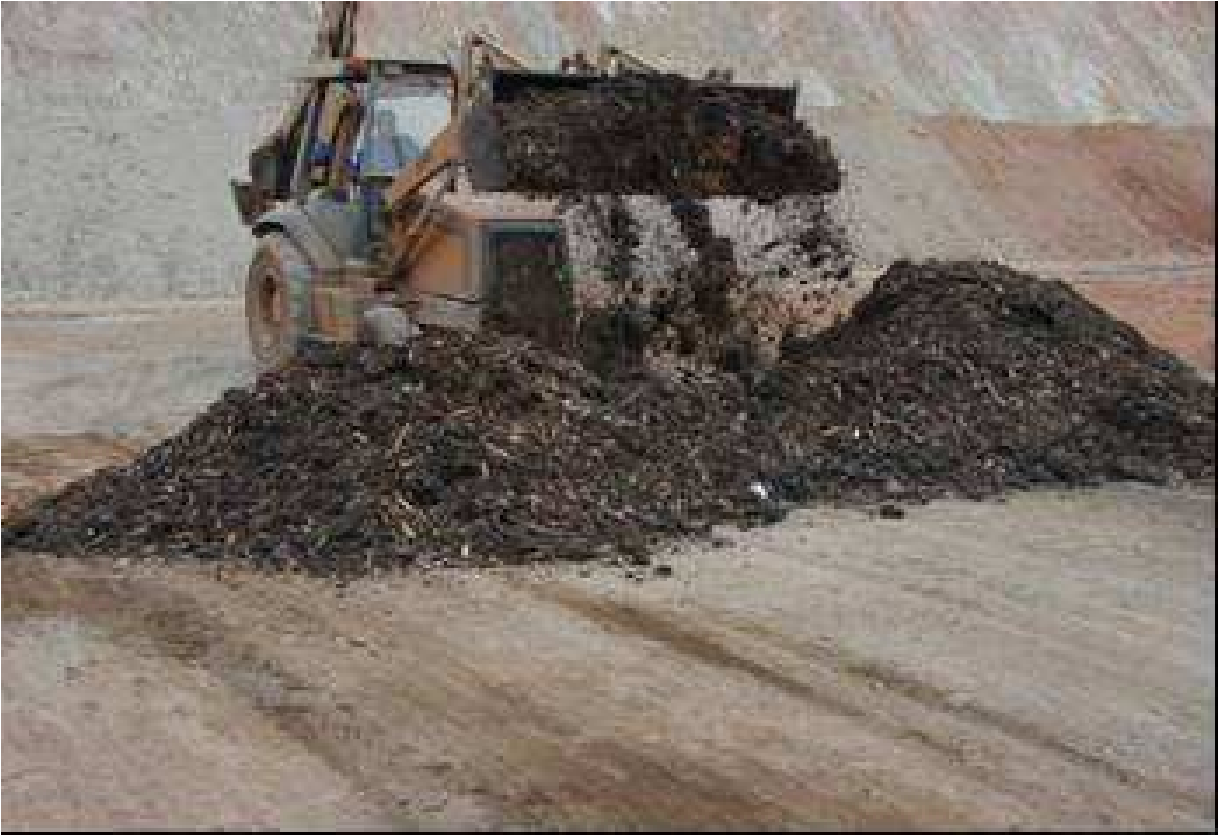
Figura 3 - Montagem das leiras de compostagem
