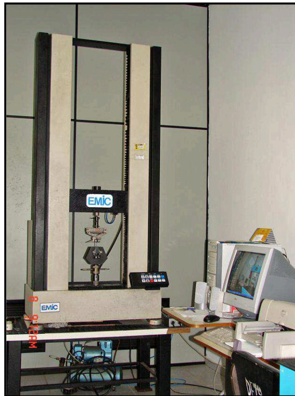
Figura 11- Máquina de Ensaio Universal EMIC
