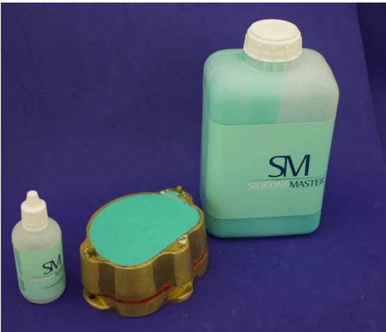
Figura 5- Silicone de duplicação laboratorial, mufla preenchida
