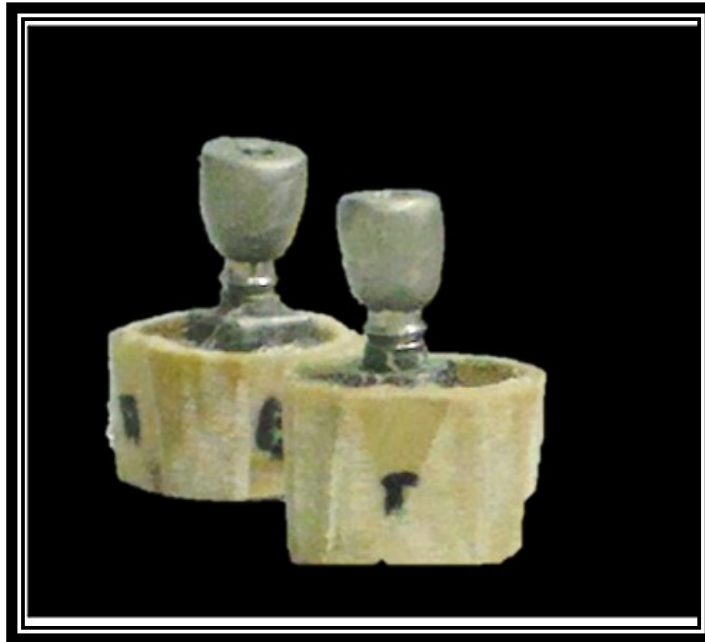
Figura 10 – Corpos de prova sob suporte de PVC prontos para ciclagem mecânica
