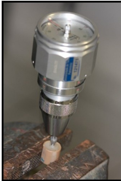
Figura 13 – Destorque dos parafusos de fixação pós ciclagem mecânica.
