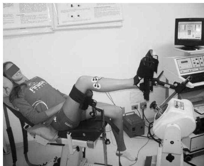
Figura 1. Posicionamento da atleta no dinamômetro isocinético para a avaliação dos movimentos passivos de inversão e eversão com o tornozelo em posição neutra (posicionado a 90° em relação à perna).
