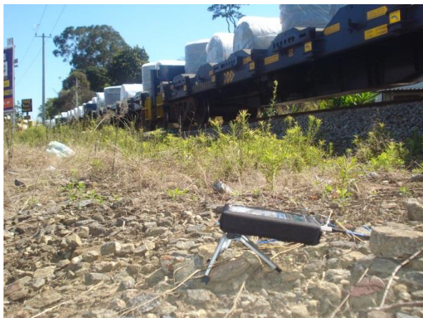
Figura 3 - Vista do equipamento de medição durante a aquisição de dados da composição ferroviária a partir do ponto de medição 3
