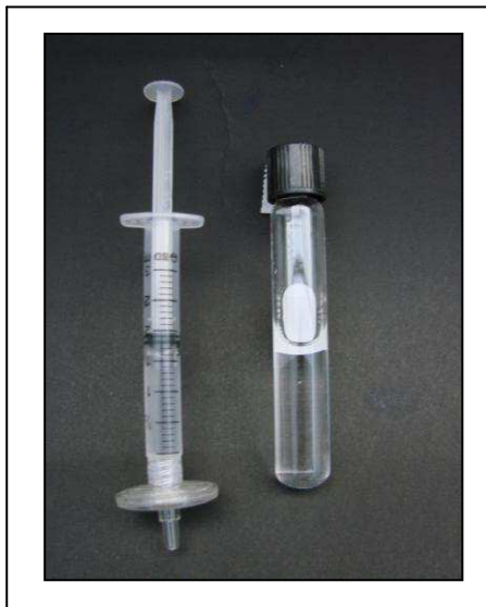
Figura 1 – Preparo das soluções. Todas as soluções foram previamente filtradas (membrana filtrante 0,2 \mu m GV Millex estéril - Millipore-Bedford ® , MA, USA)
