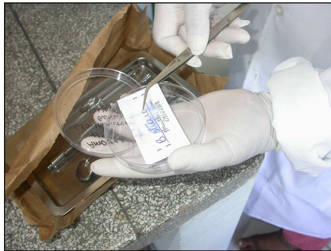
Figura 2 - Envelope com indicador biológico sendo colocado dentro da placa de Petri estéril com auxílio de pinça estéril
