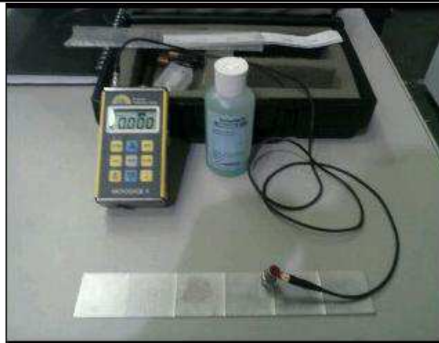
Figura 5 - Equipamento de ultrassom com bloco padrão e gel de aplicação.
