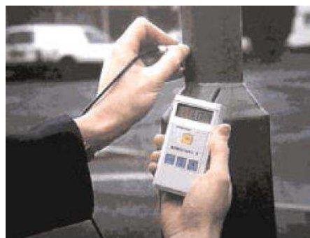
Figura 2 - Medição de espessura por Ultrassom. Autor Moacir Ramos (2009)
