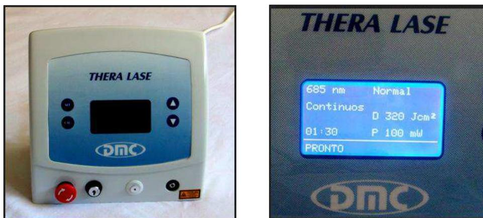
Figura 7 – Equipamento Thera Lase (DMC) – laser de diodo de baixa potência
