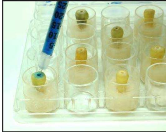
Figura 9 – Preenchimento das amostras com azul de metileno 0,01%
