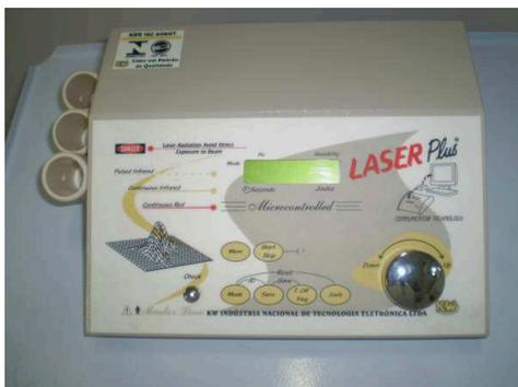
Figura 3 – Laser de baixa potência (830 nm)
