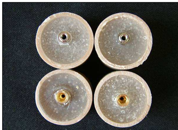
Figura 5 - Corpos-de-prova após a polimerização final da resina
