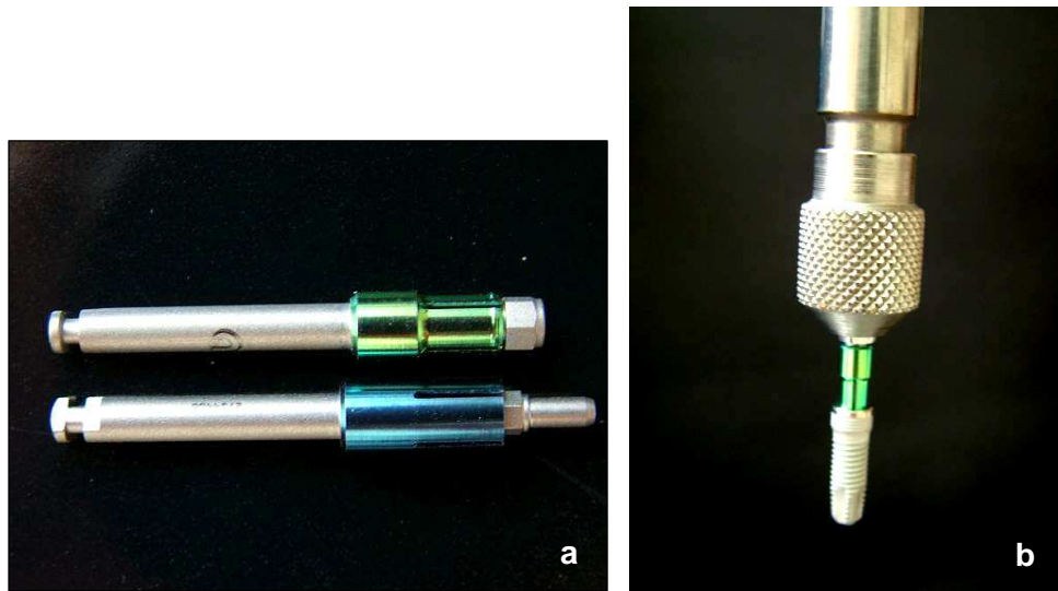
Figura 3 - Conexão para contra-ângulo para hexágono interno e externo (a), implante acoplado à haste vertical do delineador (b)
