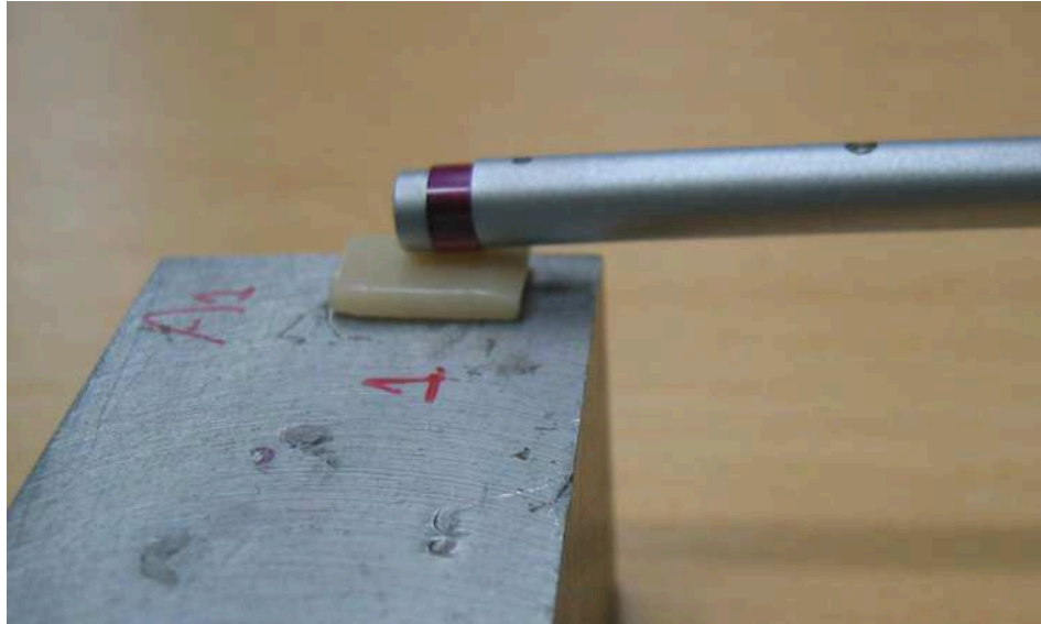
Figura 14 – Leitura da rugosidade superficial do corpo-de-prova pelo rugosímetro de superfície
