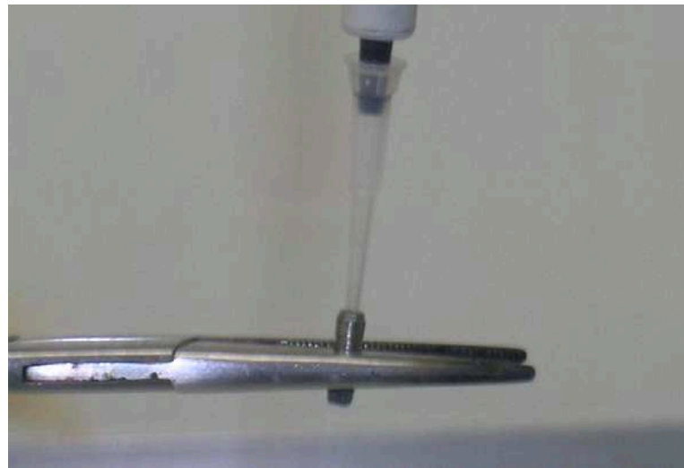
Figura 18 - Contaminação do interior do implante com micropipeta
