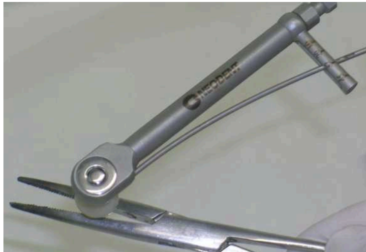
Figura 20 – Pilar protético recebendo torque de 32 N.cm
