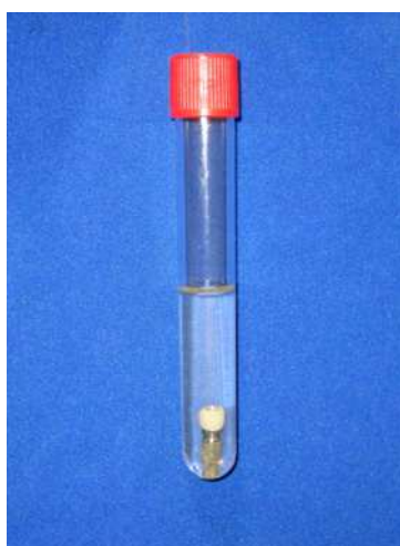
Figura 23 - Corpo-de-prova imerso em tubo de ensaio, contendo 5 ml de caldo tioglicolato esterilizado
