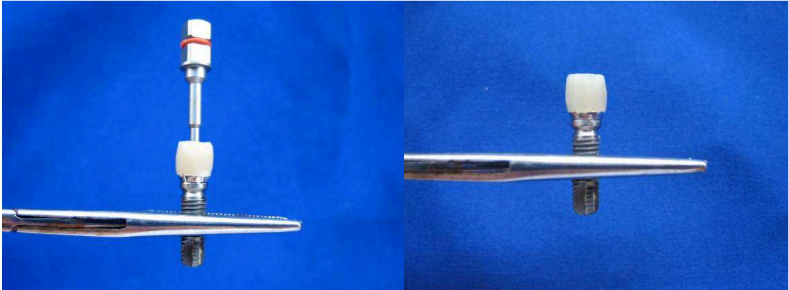
Figura 19 – (a) Coroa protética parafusada sobre o implante, (b) vista frontal do corpo-de-prova
