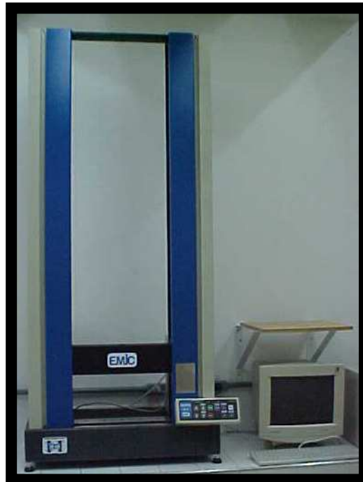
Figura 5 - Máquina de ensaio universal acoplada ao computador utilizada para analisar a resistência mecânica através do ensaio de flexão de três pontos
