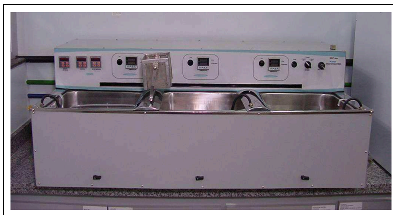
Figura 11 - Máquina de Ciclagem Térmica MCT2
