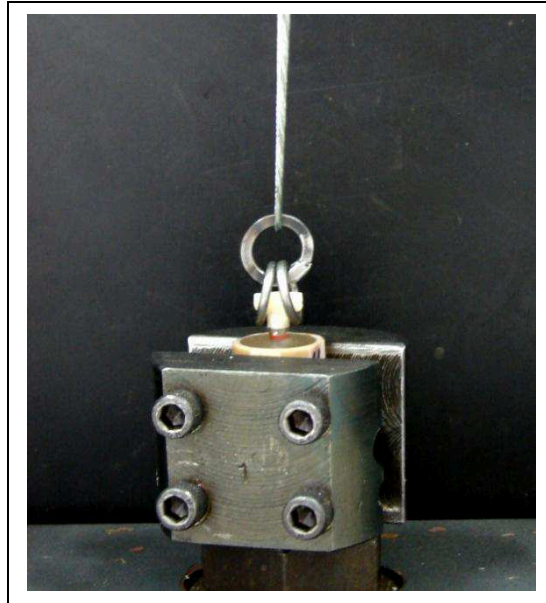
Figura 10 - Ensaio de Resistência da União à tração
