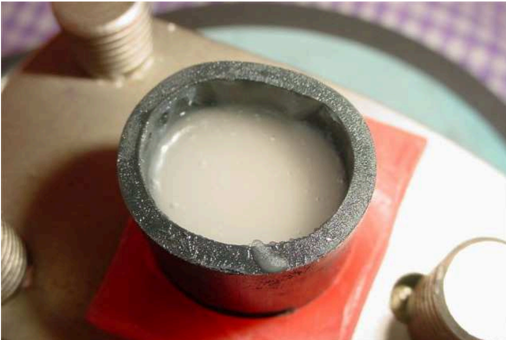
Figura 2 - Tubo \frac{3}{4} mm de polietileno preenchido com resina acrílica na consistência fluída
