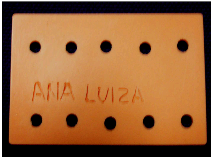
Figura 6 – Matriz de silicona utilizada para confecção do corpo-de-prova
