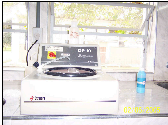
Figura 12 – Politriz elétrica rotativa de sílica coloidal
