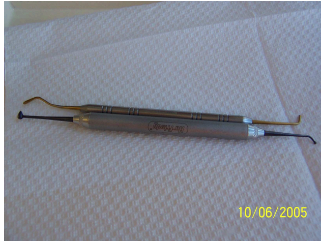
Figura 7 – Espátulas utilizadas para confecção do corpo-de-prova
