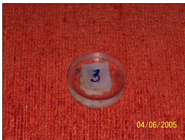
Figura 9 – Inclusão do corpo-de-prova para medição da microdureza
