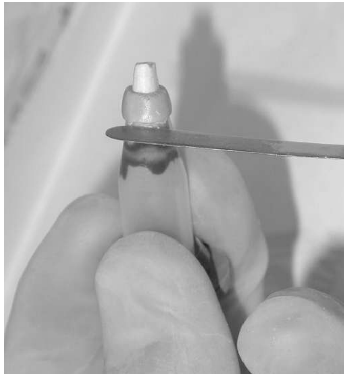
Figura 22 – Selamento da porção tubo-dente com resina epóxi
