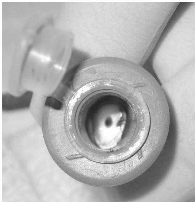
Figura 20 – Impermeabilização interna entre o Eppendorf e o dente com esmalte
