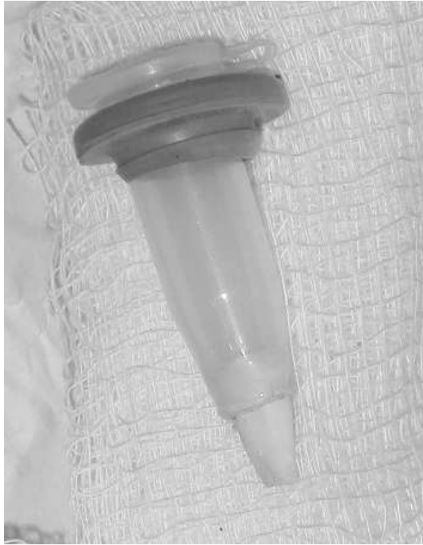
Figura 12 – Adaptação do dente e tampa de borracha ao tubo de Eppendorf
