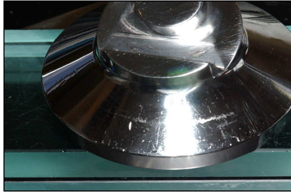
Figura 11 - Peso de 5 kg posicionado sobre o conjunto
