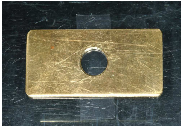
Figura 7 - Matriz e porta espécime sobre uma placa de vidro e tira de poliéster
