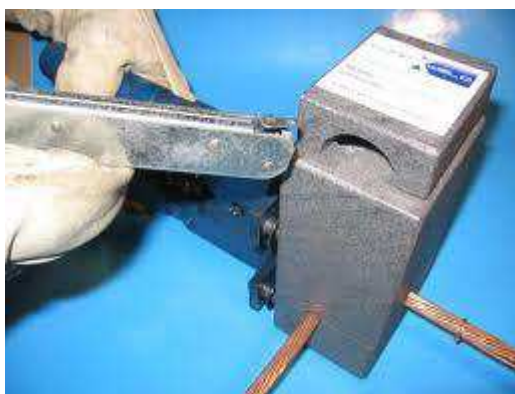
Figura 4: Molde de Grafite Fonte: Metálica Solda Exotérmica
