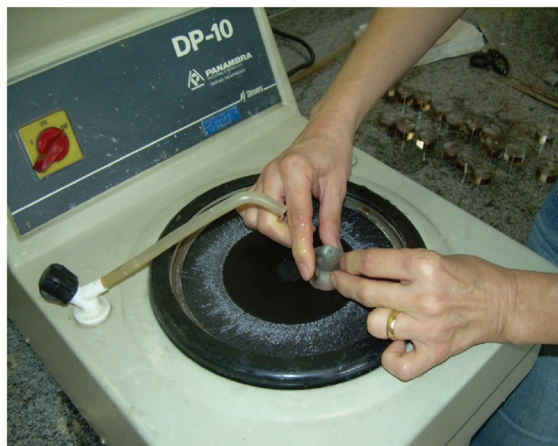
Figura 8 - Lixamento do corpo-de-prova
