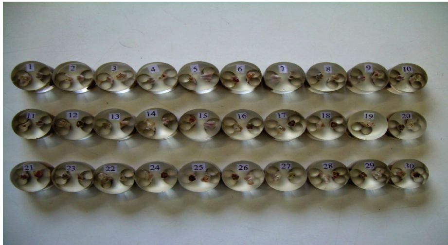
Figura 9 - Corpos-de-prova lixados e polidos
