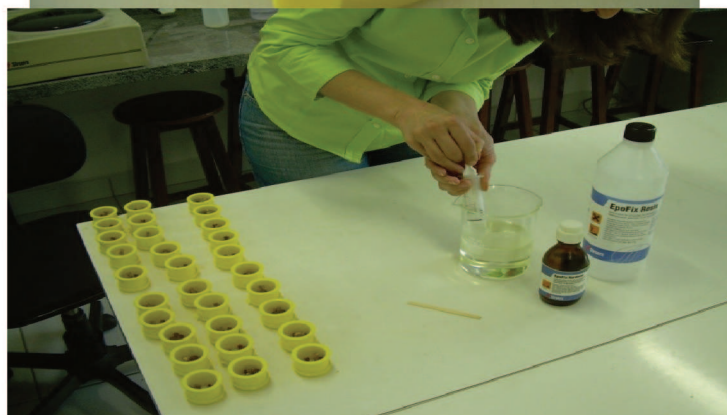
Figura 7 - Preenchimento da forma de polipropileno com resina
