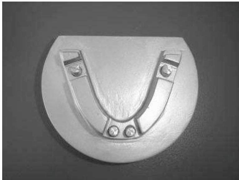
Figura 1 – Modelo mestre em aço inoxidável com marcações em “X” utilizado no presente trabalho
