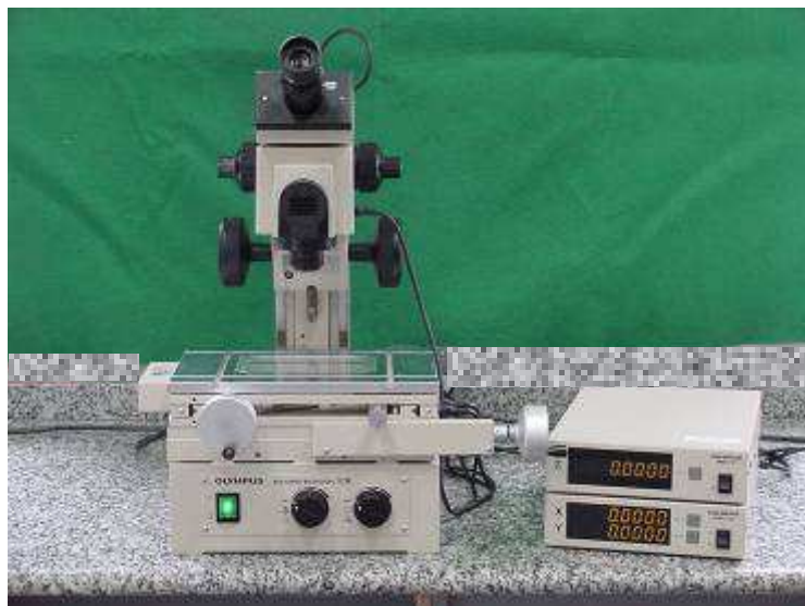
Figura 3 - Microscópio modelo STM (Olympus, Japão), onde foram realizadas as medições
