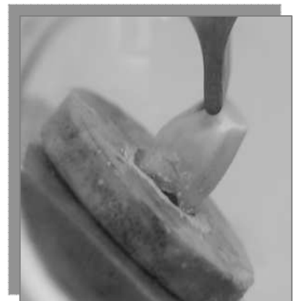
Figura 51 – Corpo-de-prova recebendo a carga, vista lateral
