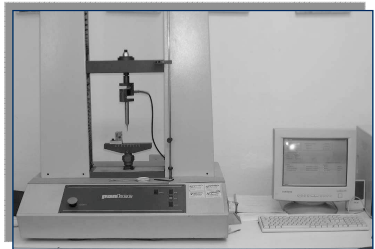
Figura 47 - Máquina Universal de Ensaio Pantec Panambra
