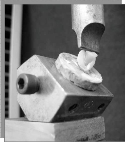
Figura 54 – Corpo-de-prova logo após a fratura
