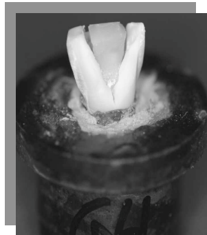
Figura 59 – Corpo-de -prova G 4 logo após a fratura
