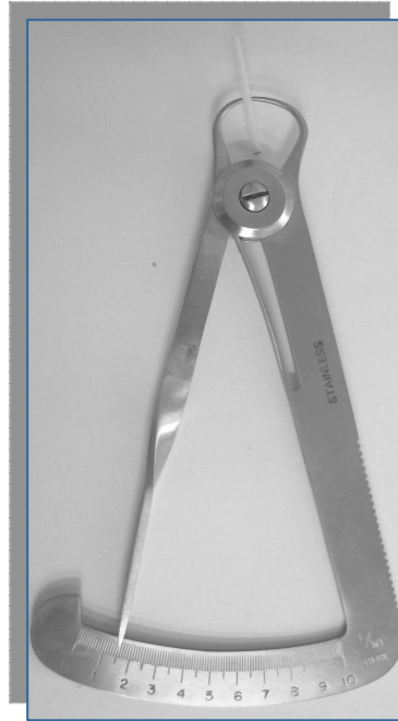
Figura 14 - Espessímetro medindo o diâmetro do pino de fibra
