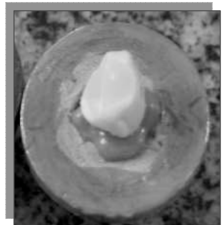
Figura 39 - Dente fixado no alvéolo com poliéter simulando o ligamento periodontal
