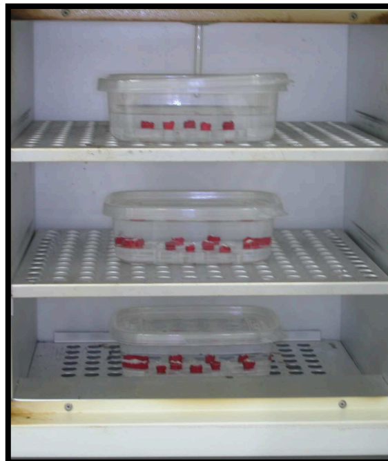
Figura 5 – Acondicionamento em estufa à 37°C dos espécimes utilizados no trabalho, durante os procedimentos de des-remineralização
