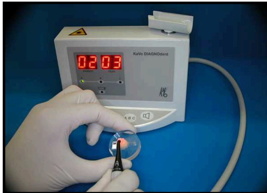
Figura 3 – Leitura da superfície oclusal de um espécime em aparelho (DIAGNOdent® KaVo, Biberach, Alemanha). Observa-se ponta laser na face oclusal do dente, valor inicial e de pico respectivamente no visor do aparelho
