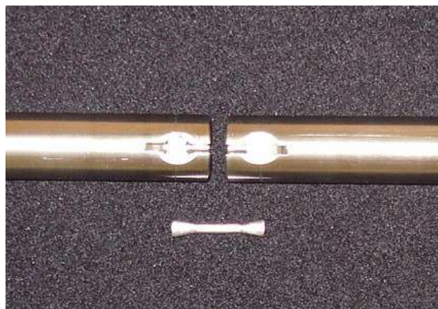
Figura 16 – Vista aproximada das garras onde os corpos-de-prova foram fixados
