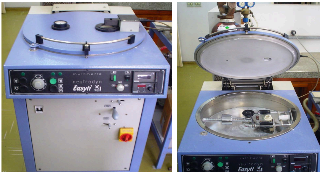
Figura 14 – Utilização da máquina de fundição por indução com ambiente controlado
