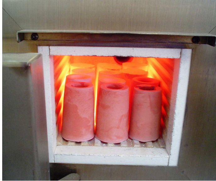
Figura 11 – Moldes sendo acondicionados no forno pré aquecido
