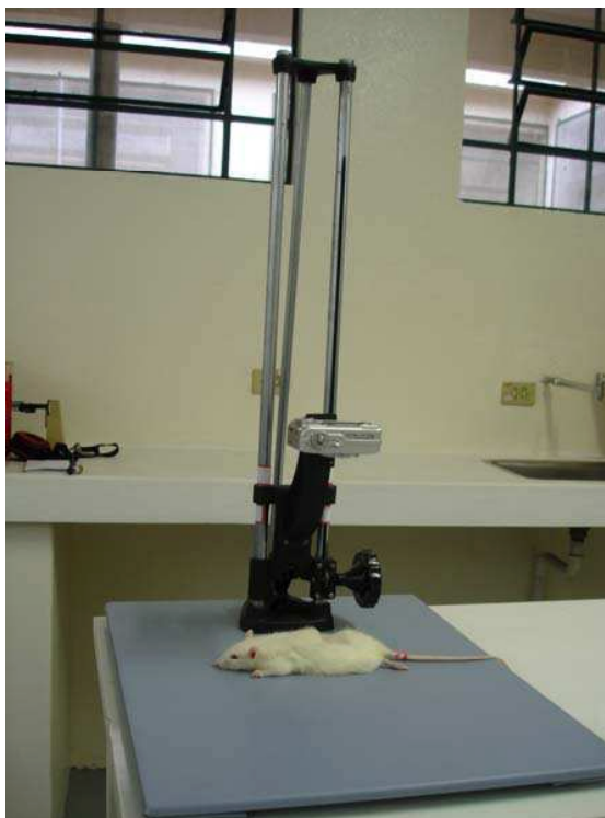
Figura 10 - Estativa utilizada para padronização das tomadas fotográficas
