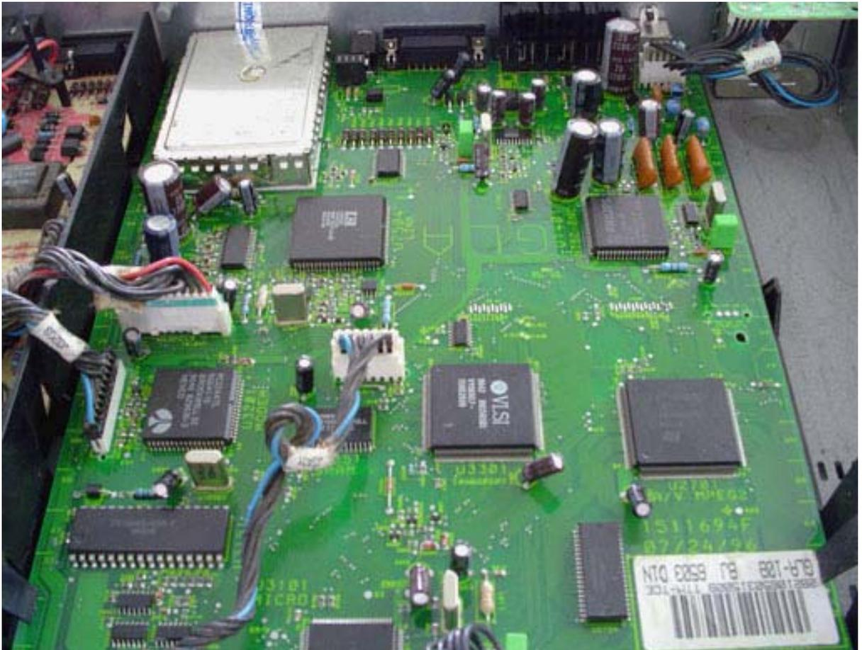
**Figura 16 – Foto placa do modelo de decodificador GLA-01 com a aplicação da resina de proteção**
