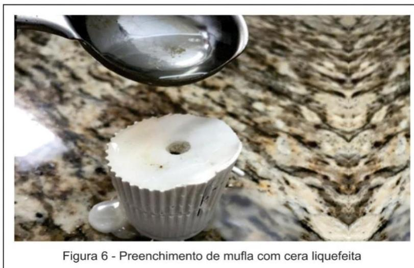
Figura 6 - Preenchimento de mufla com cera liquefeita
