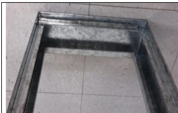
Figura 14: Mesa coletora de escoamento superficial dobra superior e inferior.
