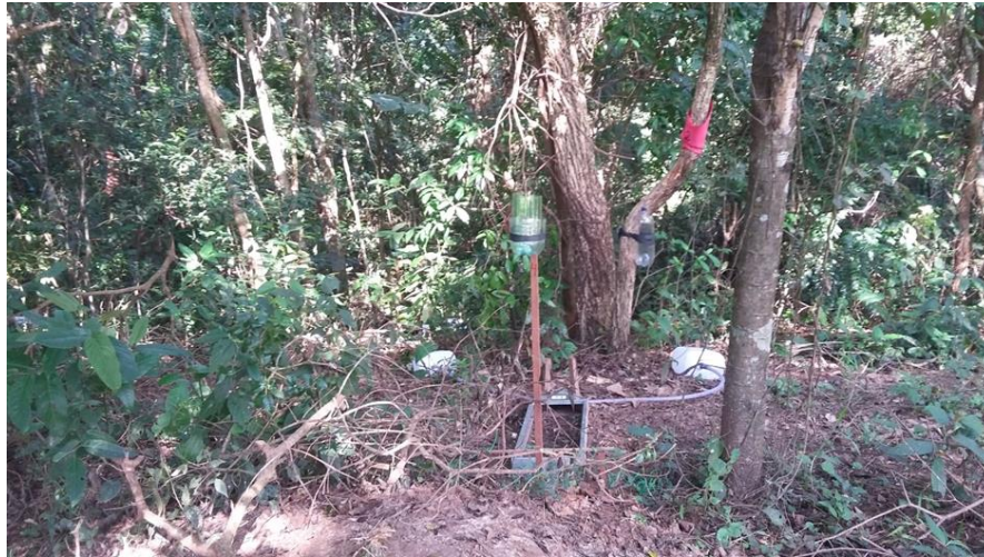
Figura 22: Instalação dos pluviômetros.
