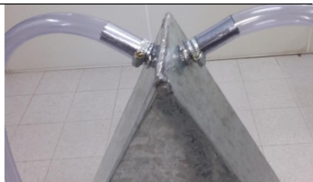
Figura 15: Mesa coletora de escoamento superficial conexão frontal
