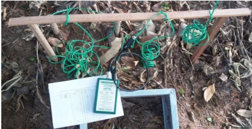
Figura 24: Instalação dos tensiômetros.
