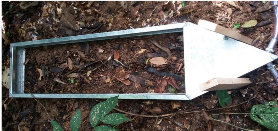
Figura 16: Mesa coletora de escoamento superficial instalada.
