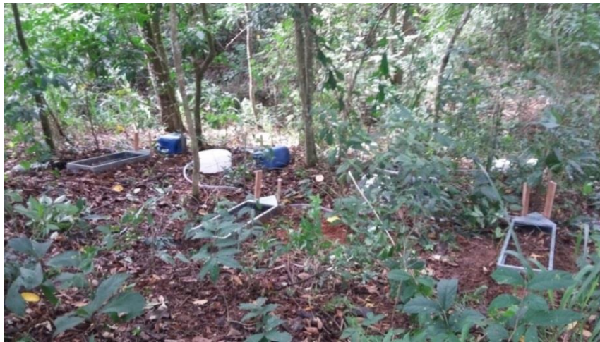
Figura 18: Galões acoplados à mesa coletora de escoamento superficial.
