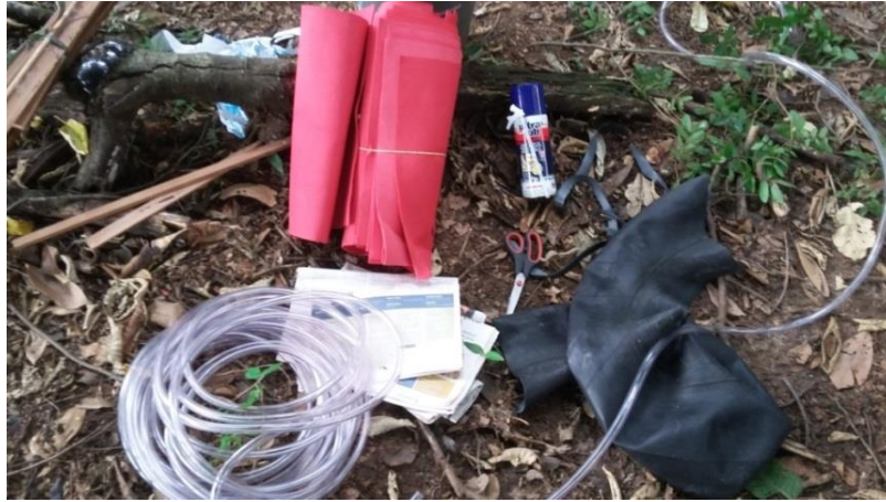
Figura 30: Materiais para montagem e instalação dos coletores de escoamento pelo tronco.
