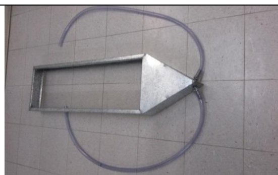
Figura 13: Mesa coletora de escoamento superficial.
