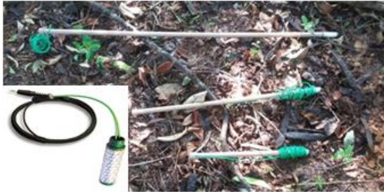
Figura 23: Sensor de tensão de água no solo Watermark TM e tensiômetros de solo (40, 60 e 120 cm.).
