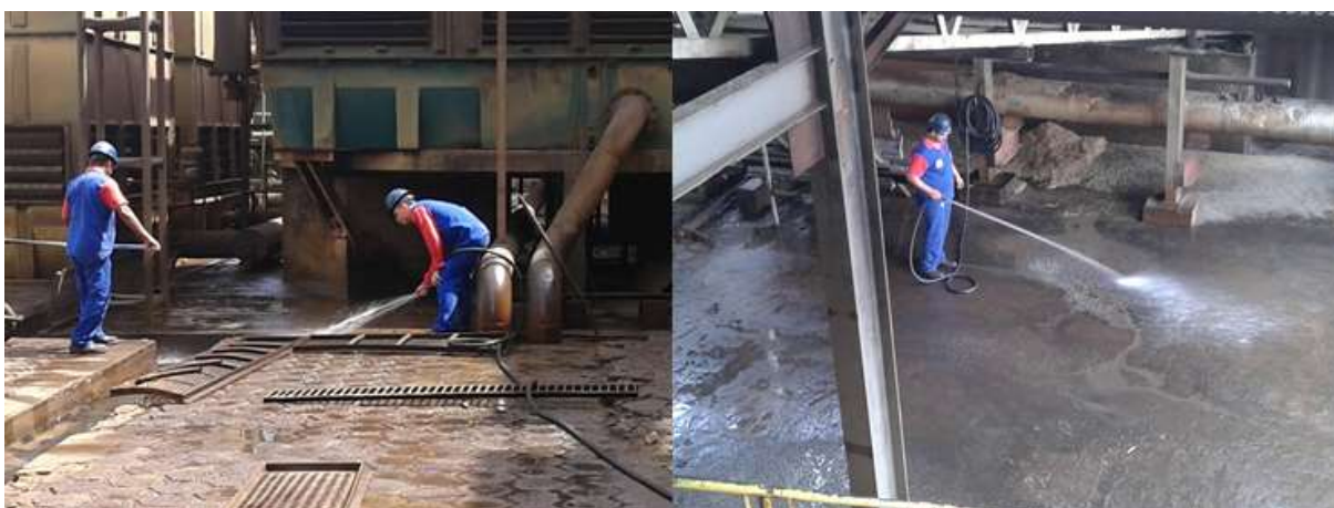
Figura 39 – Uso indevido de água como instrumento de varrição, gerando desperdício.
