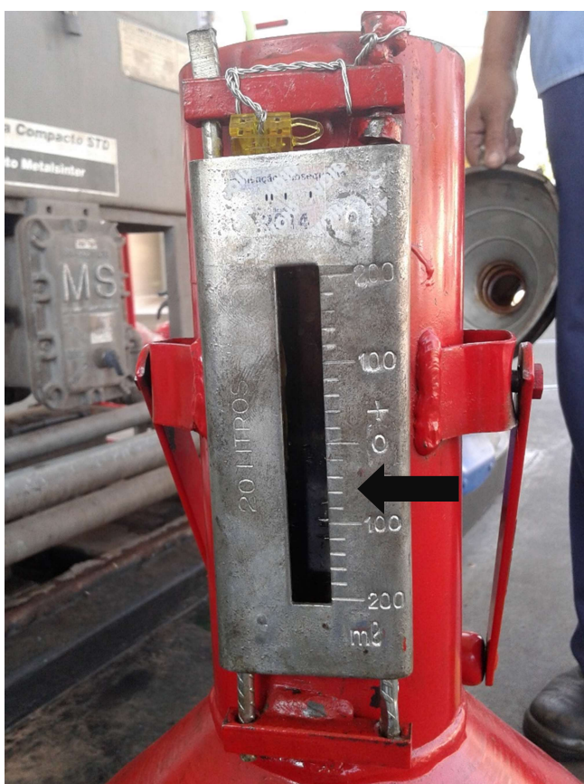
Figura 13: Balde calibrado e aferido pelo INMETRO utilizado para ajuste de nosso sistema de medição.
