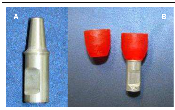
Figura 9 – A) Análogo para pilar sólido de 5,5mm. B) Corpos de prova em resina acrílica
