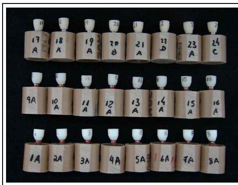
Figura 10 - Corpos de prova encaixados nos pilares
