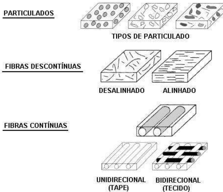
Figura 2.3 - Formas de distribuição do reforço na matriz
