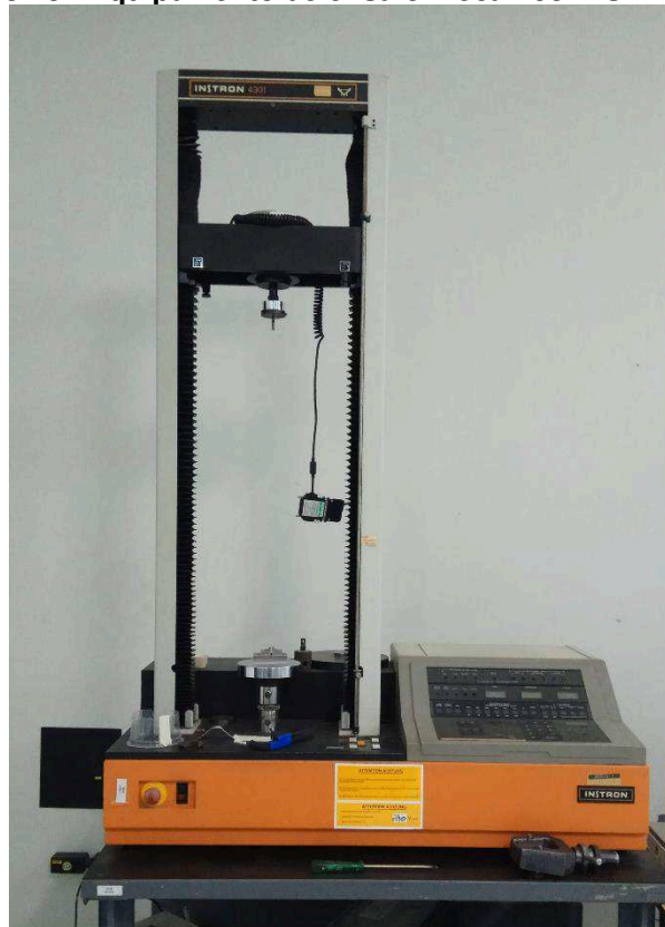
Figura 3.13 - Equipamento de ensaio mecânico INSTRON 4301
