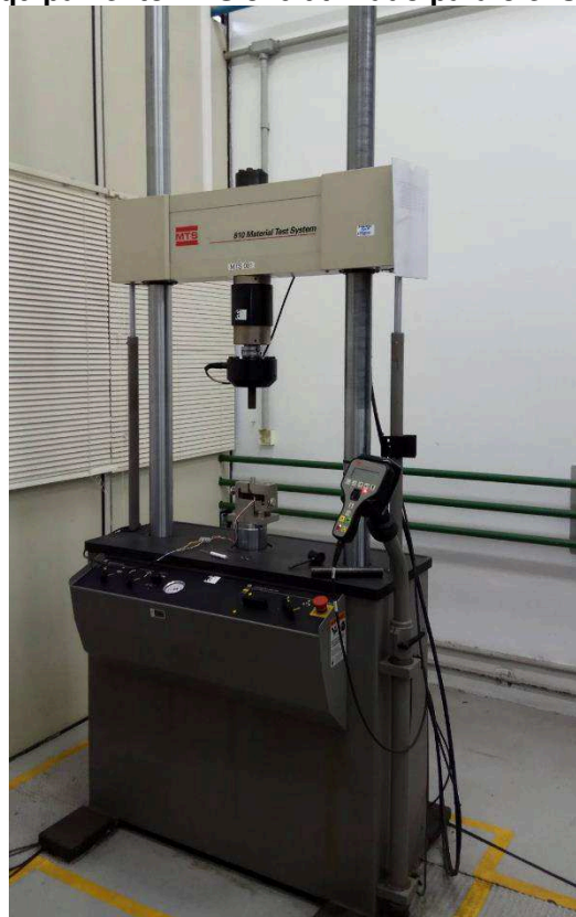
Figura 3.16 – Equipamento MTS 810 utilizado para o ensaio de losipescu
