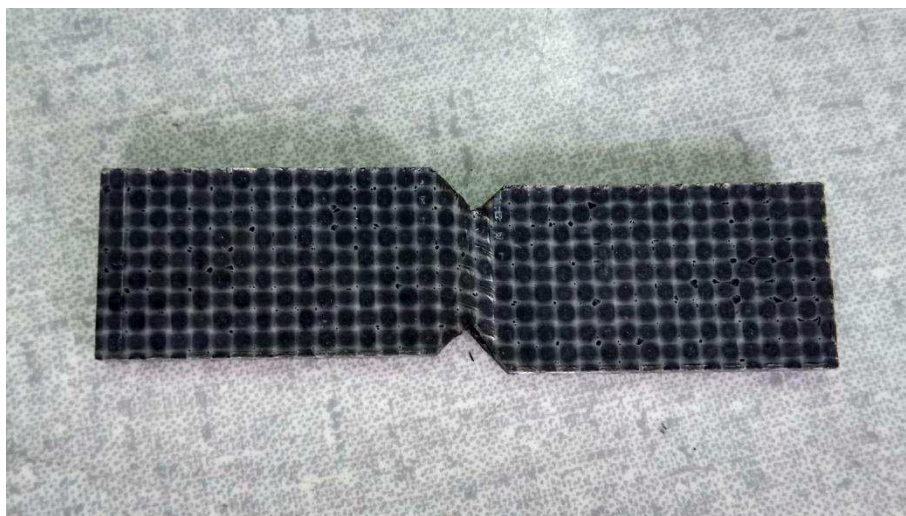
Figura 2.7 - Corpo-de-prova após ensaio pelo método de losipescu
