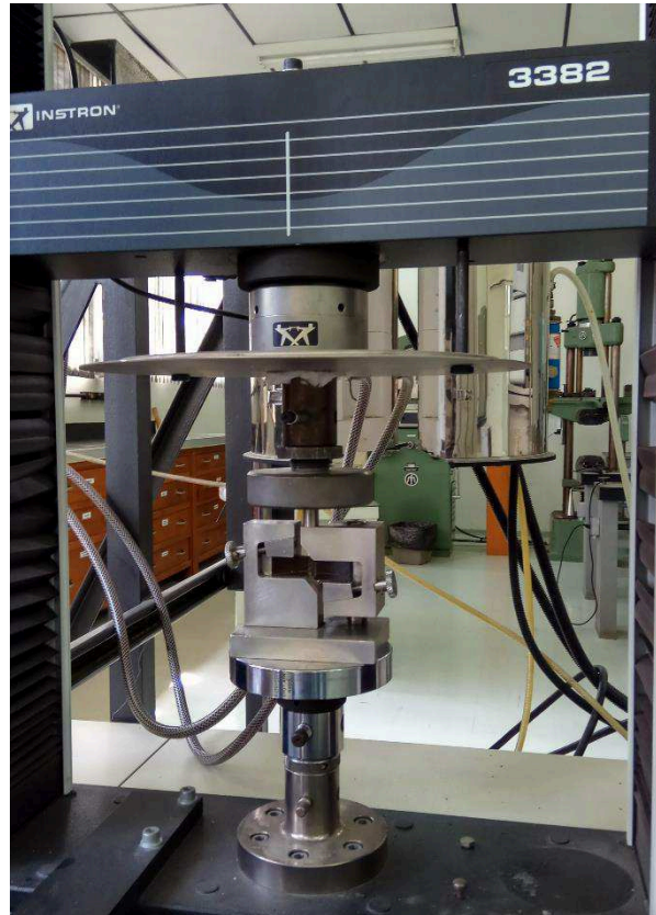
Figura 3.17 - Ensaio de losipescu no equipamento INSTRON 3382
