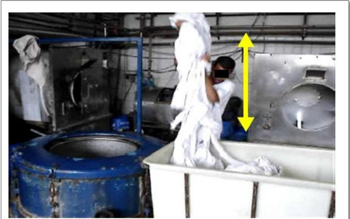
Figura 5 Carregamento de centrífuga
