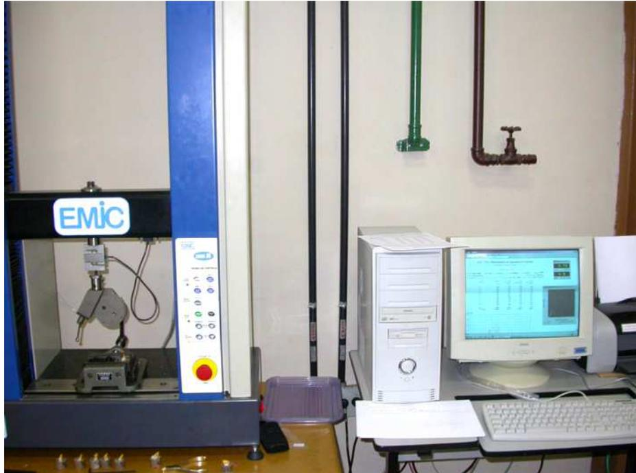
Figura 14- Máquina Universal de Ensaio Mecânico (máquina eletromecânica da marca EMIC Modelo DL 3000)
