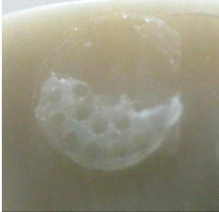
Figura 18- Fratura mista no corpo-de-prova 6 do grupo 2 que foi colado com Sistema adesivo Magic Bond
