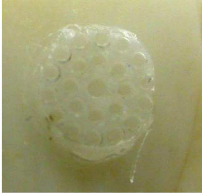
Figura 16- Fratura Coesiva no corpo-de-prova 5 do grupo 5 que foi colado com Sistema Adesivo Transbond Plus Self Etching Primer
