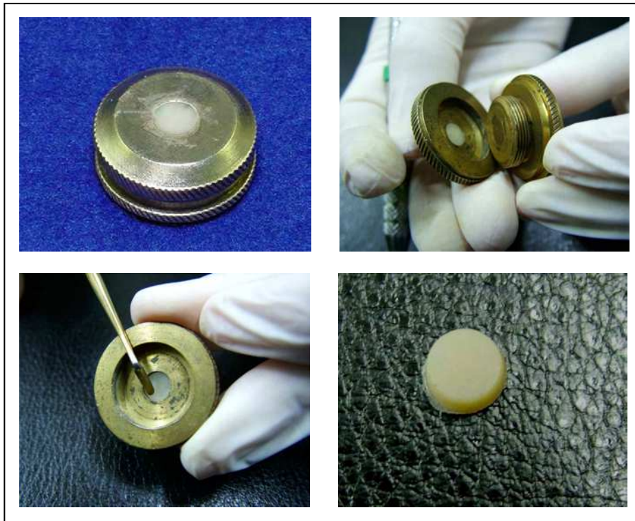
Figura 14 – Remoção do corpo-de-prova da matriz metálica
