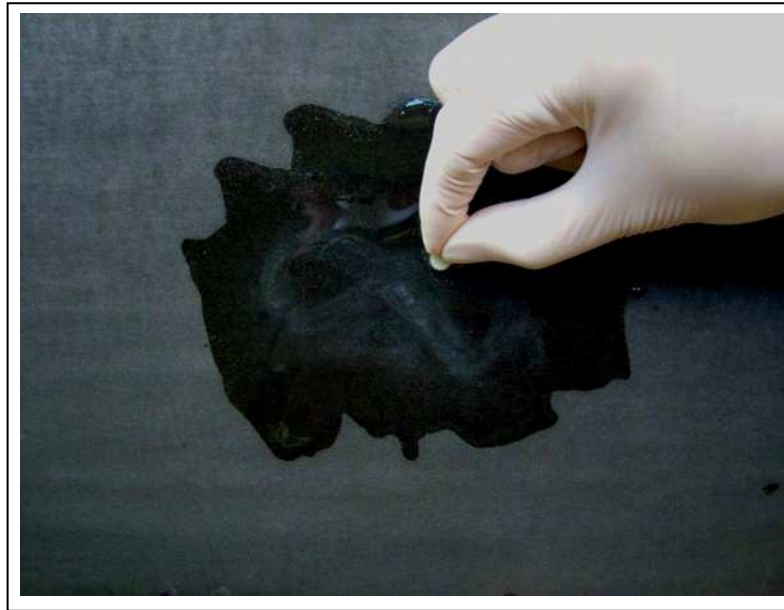
Figura 15 – Padronização da superfície do corpo-de-prova
