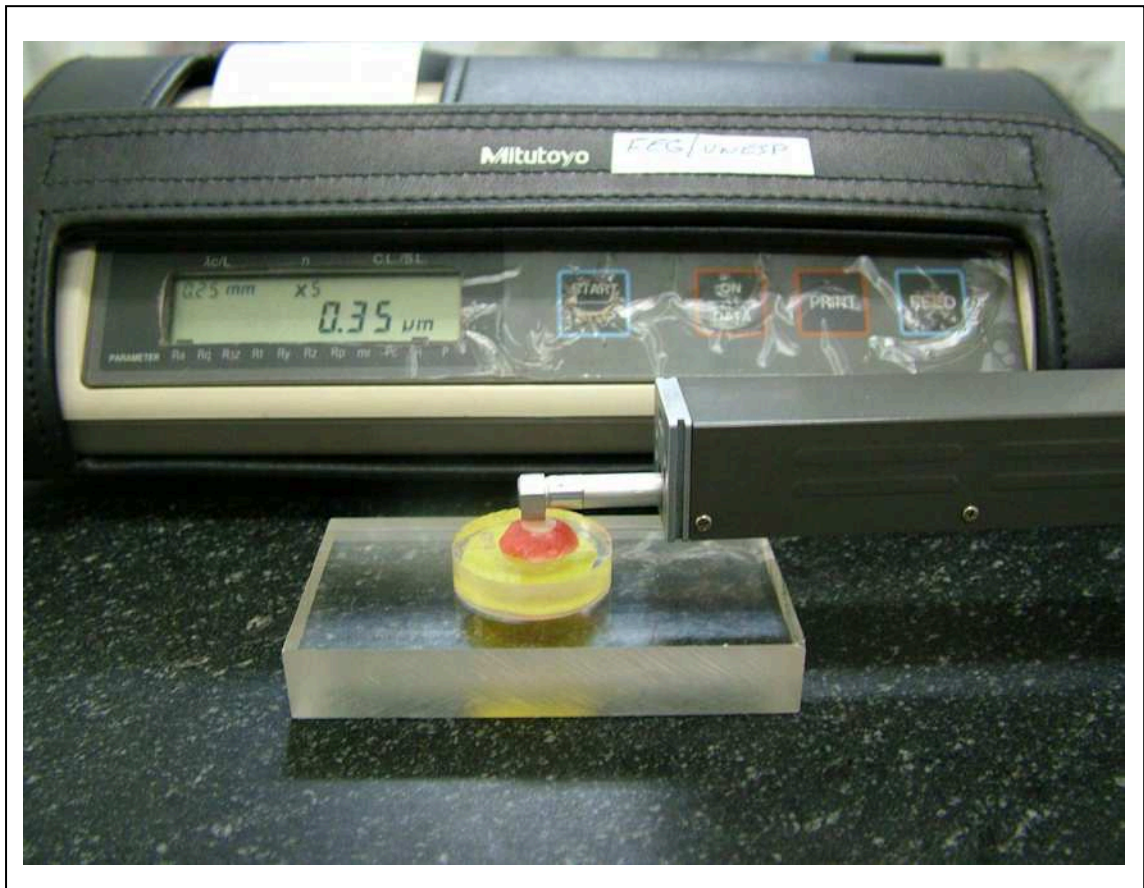
Figura 16 – Posicionamento do corpo-de-prova e mensuração da rugosidade de superfície
