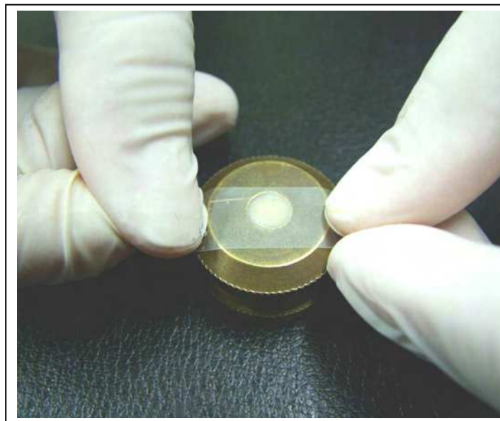
Figura 11 – Posicionamento da tira de poliéster na superfície
