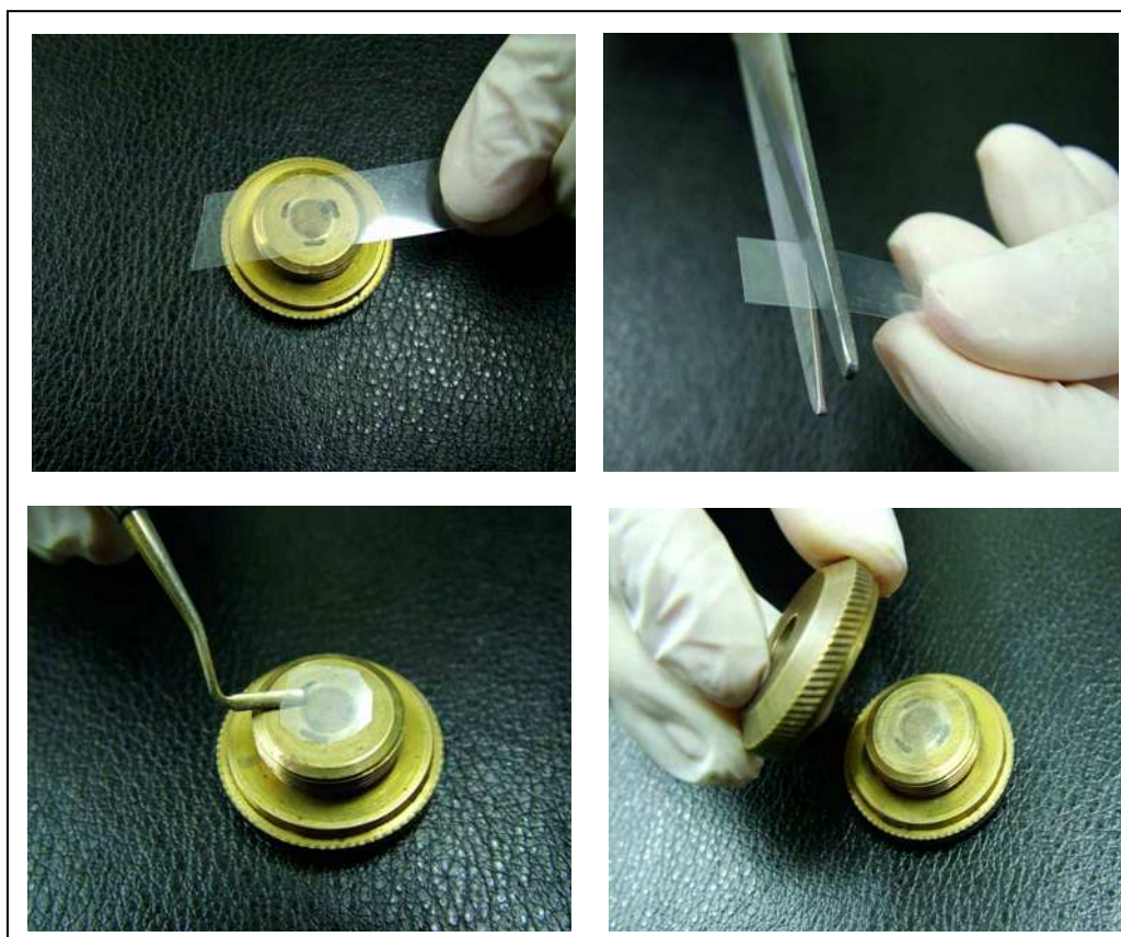
Figura 9 – Posicionamento da tira de poliéster na base
