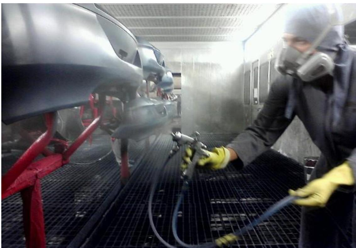
Figura 9: Pistola com angulação de aproximados 20° para locais de difícil acesso.
