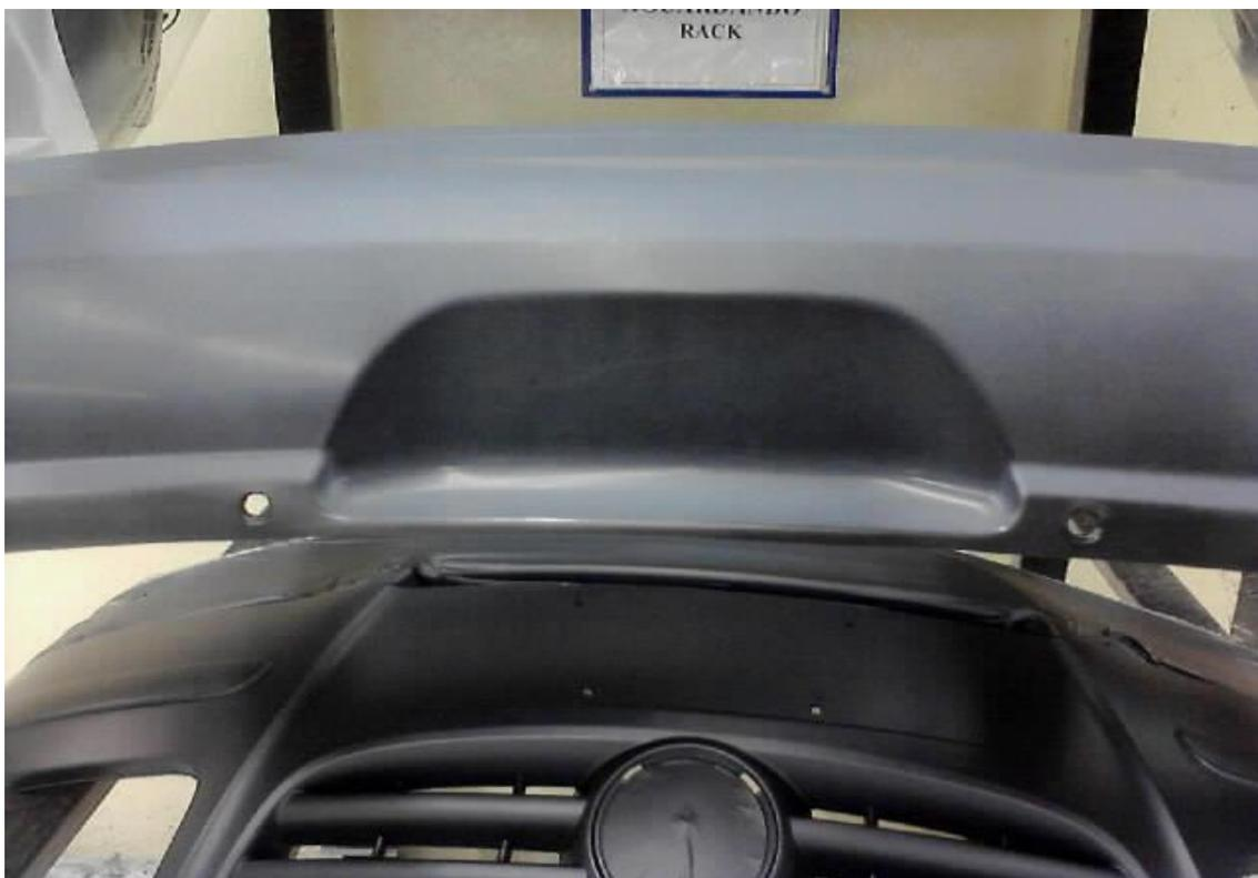
Figura12: Aplicação da tinta com a pistola em posição perpendicular ao dispositivo suporte na condição atual.
