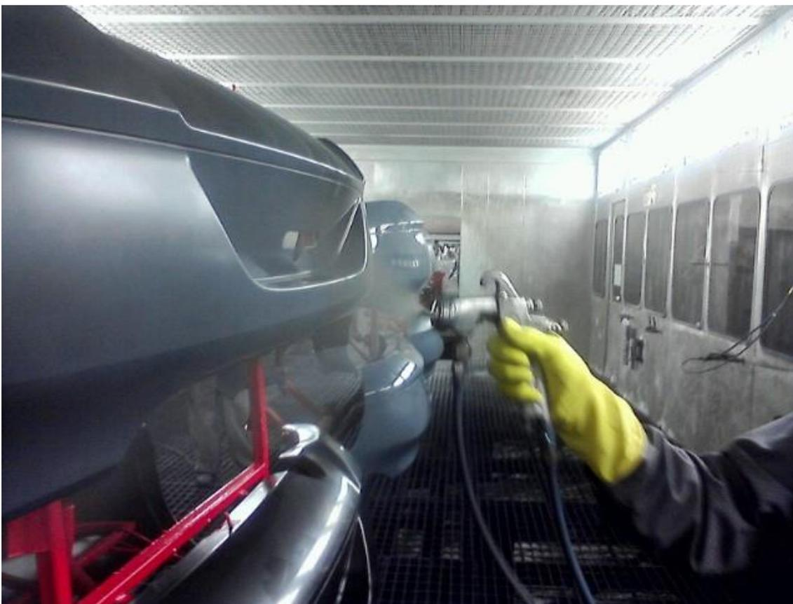
Figura 10: Posição ideal da pistola para que o pintor não se submeta a torções.
