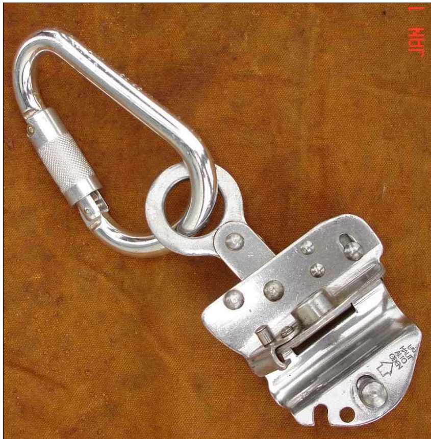
Figura 9 Trava-quedas com mosquetão Fonte: ISA CTEEP (2009)
