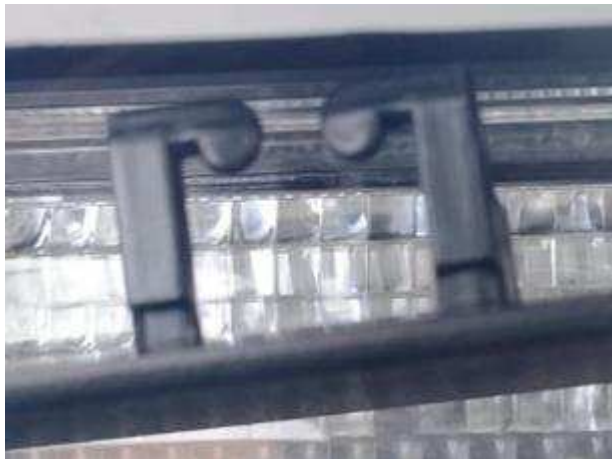
Figura 11 – Clips mal injetado
