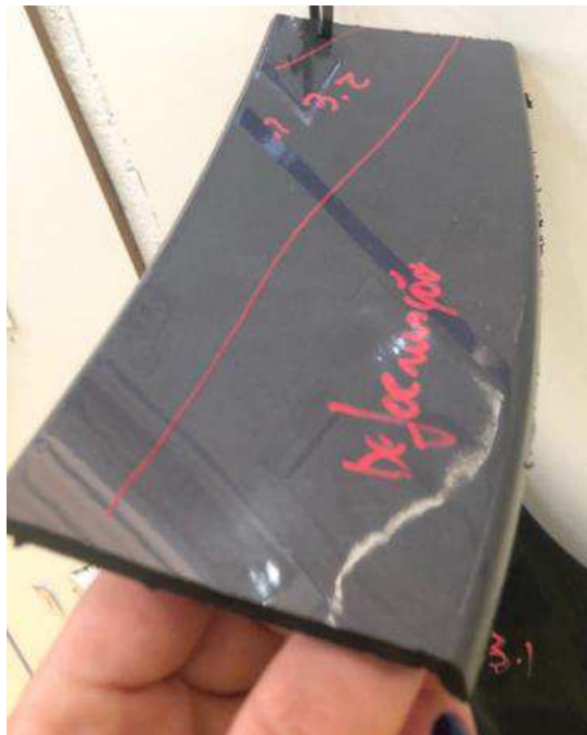
Figura 15: Exemplo de Empenamento
