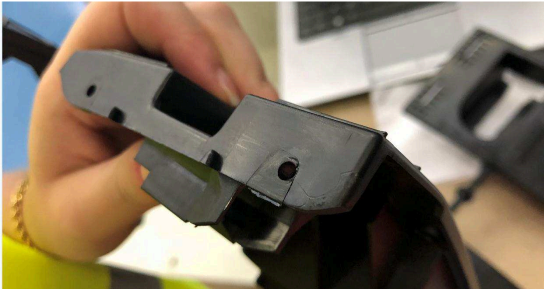
Figura 12: Exemplo de Rebarba
