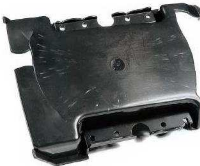
Figura 8 – Marcas de Fluxo
