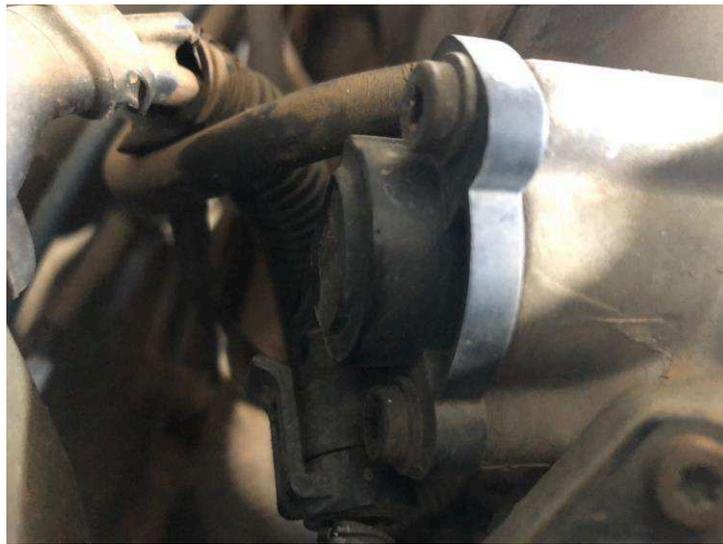
E a substituição do sensor MAP (Figura 17), pois o motor apresentava alterações na marcha-lenta.
