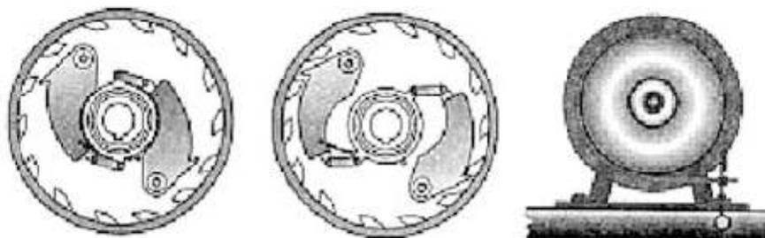
Figura 23 Freio centrífugo no eixo do carretel
