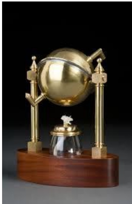
Figura 1 Motor a vapor de Heron de Alexandria
