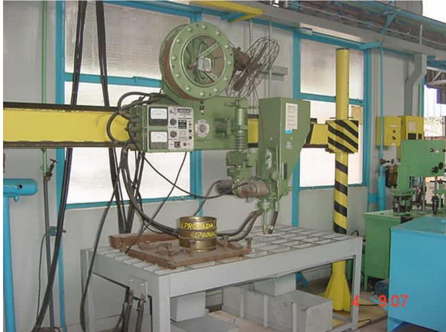
Figura 6: Máquina de Solda Tubular.
