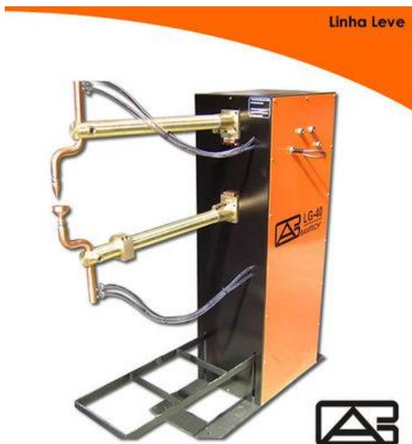
Figura 18: Máquina de Solda Ponto.
