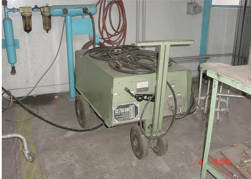
Figura 13: Máquina Solda Elétrica.
