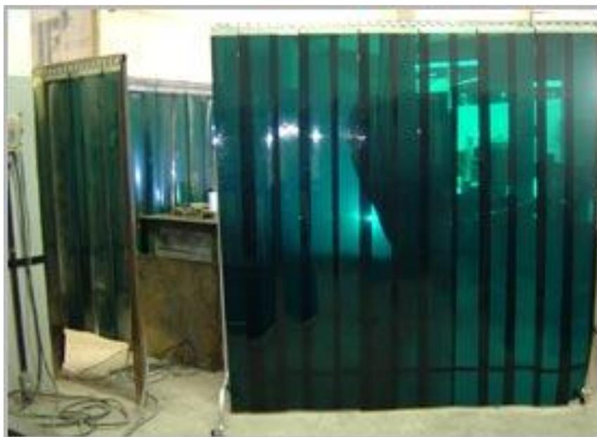
Figura 39: Biombo de Soldagem Móvel.
