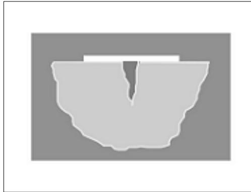
Figura 4 Aplicação do revelador e observação da indicação.
