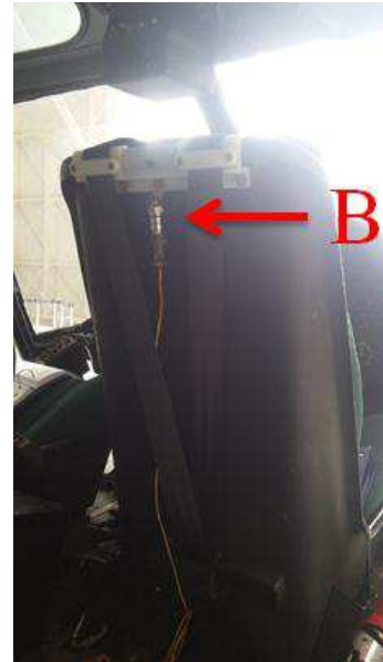
FIGURA 40: Acelerômetro (A) instalado próximo aos pés do piloto o acelerômetro (B) instalado próximo à coluna do piloto.
