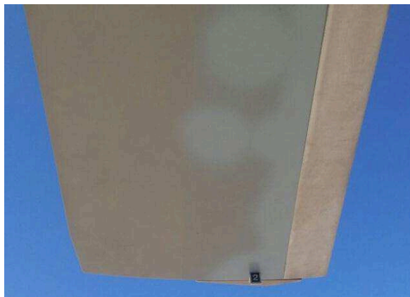
FIGURA 36: Cibla instalada na ponta da pá.
