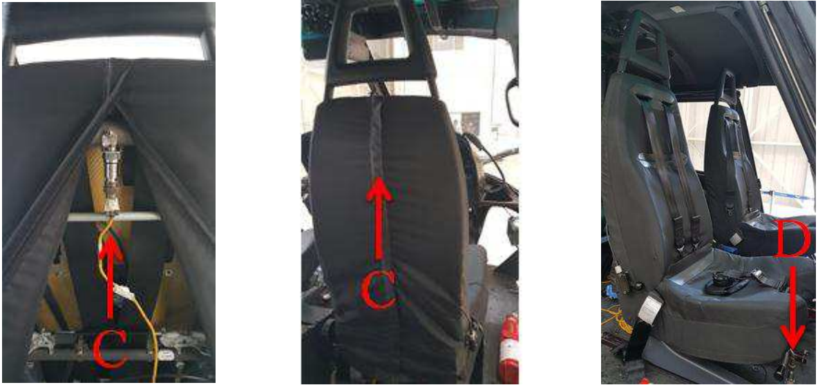
FIGURA 41: Acelerômetro (C) instalado próximo à coluna do piloto e o acelerômetro (D) instalado próximo aos pés do piloto.
