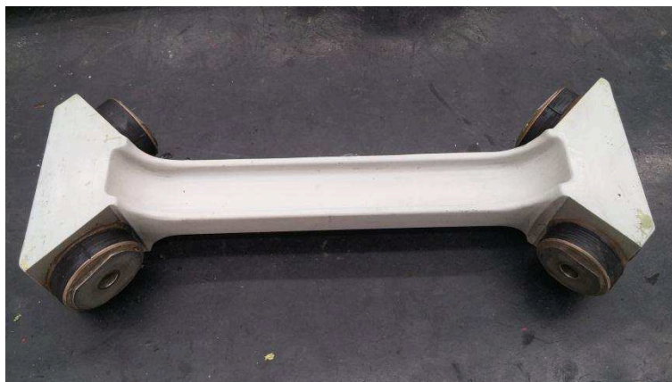
FIGURA 3: Montante instalado na barra bidirecional da aeronave AIRBUS AS 350.
