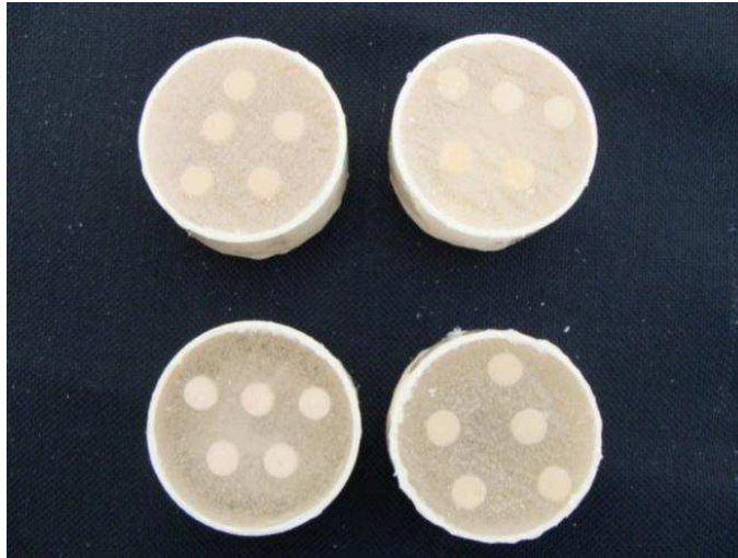
Figura 15 - Corpos-de-prova embutidos em resina para ensaio de microdureza
