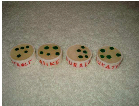
Figura 21 – Corpos-de-prova para ensaio de microdureza
