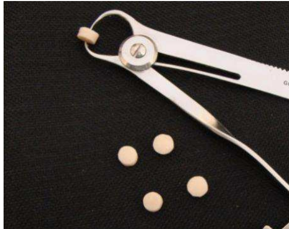
Figura 12 – Corpos-de-prova para ensaio de microdureza e análise da rugosidade superficial
