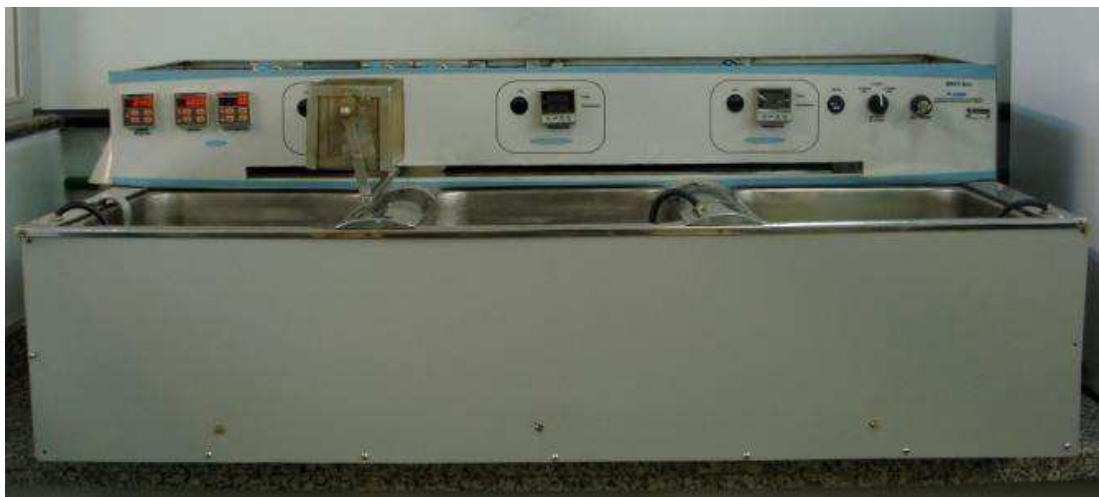
Figura 33 - Termociclador MSCT – 3 PLUS
