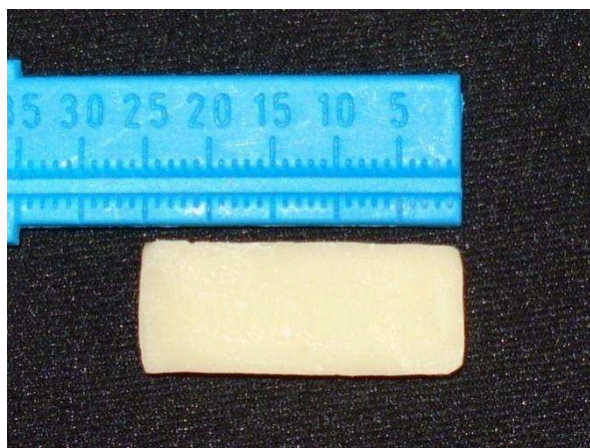
Figura 14 - Corpos-de-prova para avaliação da estabilidade de cor
