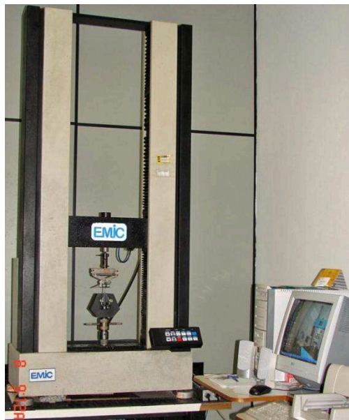
Figura 17 – Máquina de ensaios universais EMIC DL 10000
