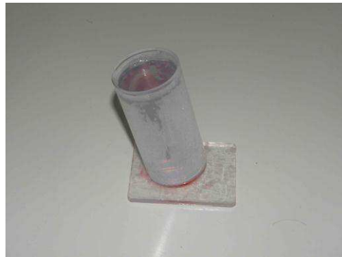
Fig 7. Dispositivo confeccionado para padronização dos procedimentos de jateamento.
