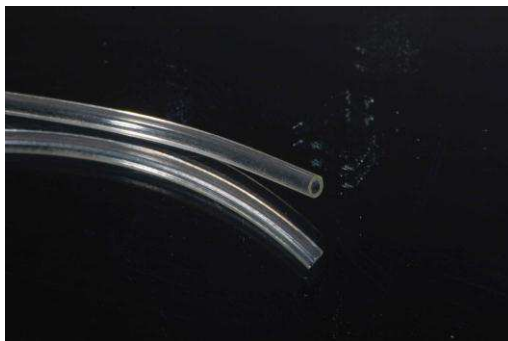
Fig. 14. Matriz transparente cilíndrica (Tygon) utilizada para obtenção dos postes de cimento.
