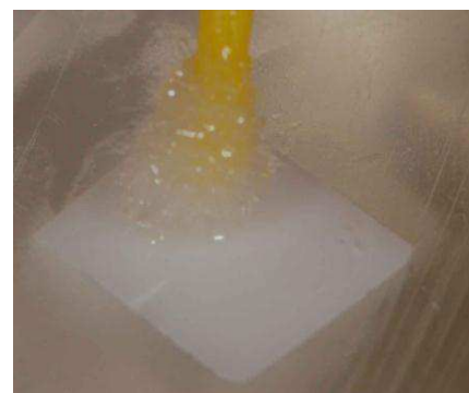
Fig. 11. Aplicação do silano sobre a superfície da cerâmica nos respectivos grupos.
