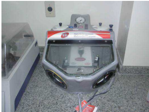
Fig. 6. Equipamento para realização dos procedimentos de jateamento.
