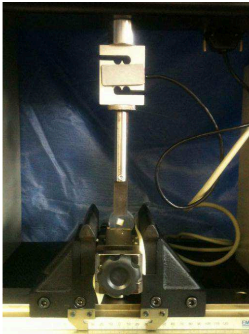
Fig. 23. Amostras posicionadas sobre dispositivo na máquina de ensaio universal.
