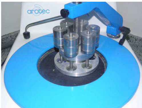
Fig. 4. Polimento com lixa d'água de granulação 300, 600, 1200 e 1500 em politriz.
