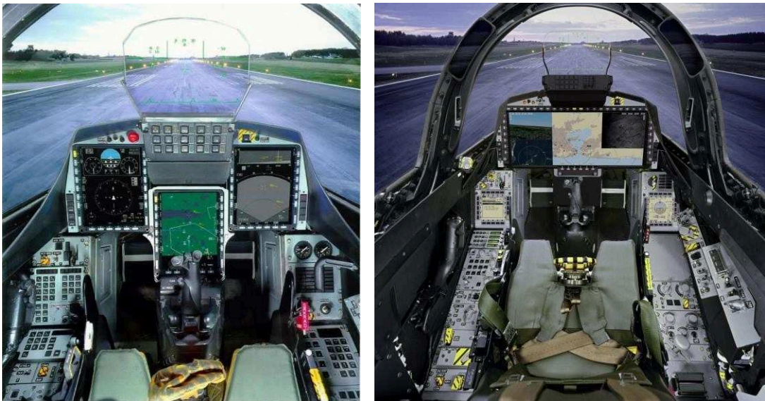
Figura 28 - Comparativo entre os cockpits das versões C/D (à esquerda) ( http://www.cavok.com.br/blog/poder-sueco-saab-j-39-gripen/ ) e E/F do caça Saab Gripen (à direita) ( https://www.aereo.ior.br/2018/04/12/defexpo-na-india-saab-apresenta-wad-no-simulador-do-caca-gripen-e/ ).
