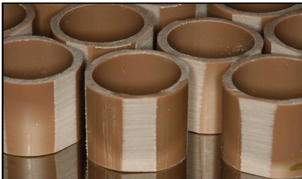
Figura 2 – Tubos de PVC cortados em torno de precisão e superfícies aplainadas
