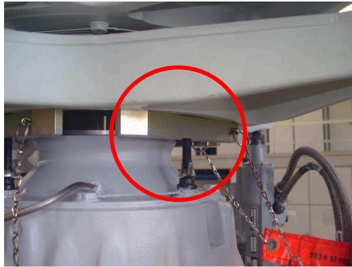
FIGURA 36 - Calços para elevação da swash plate
