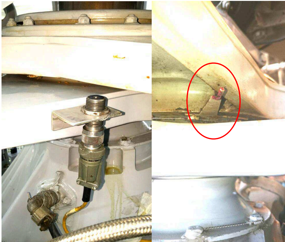
FIGURA 48 - Captor magnético instalado no mastro do rotor principal e o ferrolho de excitação do captor.
