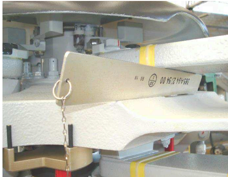
FIGURA 38 - Local de verificação da régua no punho
