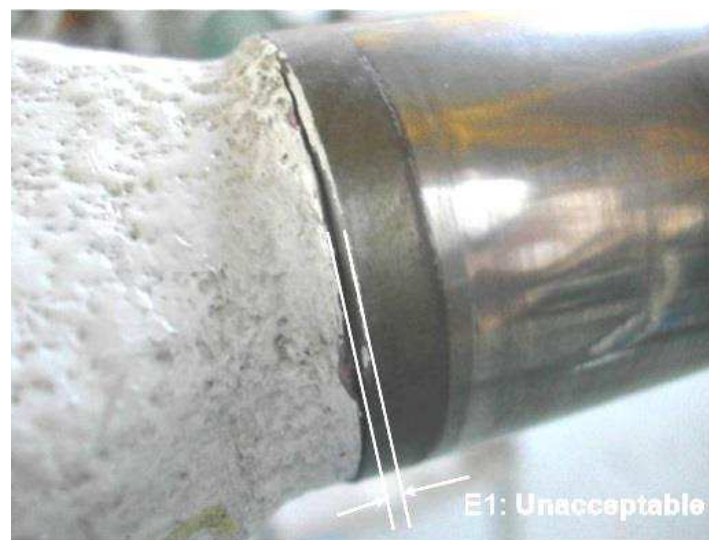
FIGURA 61 - Descolamento da bucha do braço da estrela.
