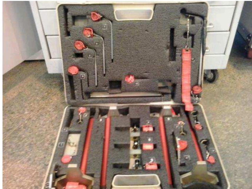
FIGURA 24 - Conjunto de ferramentas para Rigagem dos comandos de voo
