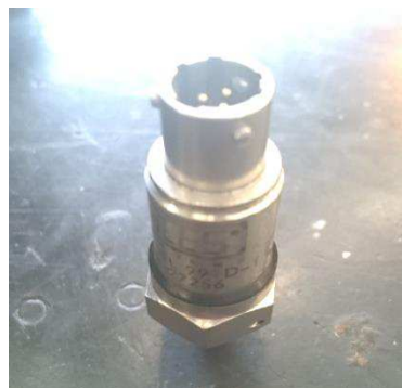
FIGURA 15 - Acelerômetro ACES 991D1
