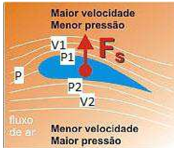
FIGURA 6 - Princípio de Bernoulli para sustentação de perfis aerodinâmicos
